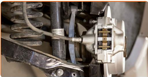
**14** Pievelciet stiprinājumu, kas savieno stabilizatora atsaiti pie stabilizatora stienņa. Izmantojiet kombinēto atslēgu Nr 17. Izmantojiet kombinēto atslēgu Nr 19. Izmantojiet dinamometrisko atslēgu. Griezes moments 30 Nm.
