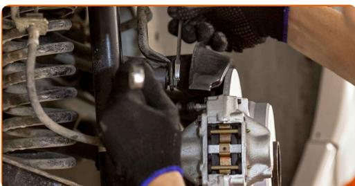
**15** Uzstādiet stiprinājumu, kas savieno stabilizatora stieپni ar balstiekārtas sviru, un pievelciet to. Izmantojiet kombinēto atslēgu Nr 13. Izmantojiet mucīņatslēgu Nr 13. Izmantojiet mucīņatslēgu Nr 17. Izmantojiet dinamometrisko atslēgu. Griezes moments 20 Nm.
