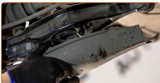
**8** Notīriet stabilizatora atsaites stiprinājumus. Izmantojiet metāla birsti. Izmantojiet WD-40 aerosolu.
