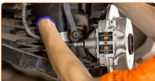
**12** Notīriet stabilizatora stieņa montāžas sēžas. Izmantojiet metāla birsti. Izmantojiet WD-40 aerosolu.
