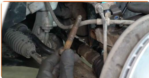
**30** Atlaidiet apakšējo stiprinājumu, kas savieno amortizatora statni pie grozāmass. Izmantojiet speciālu mucīņu amortizatora demontāžai. Izmantojiet atslēgu ar tarkšķi.
