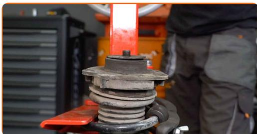
**36** Apstrādājiet amortizatora statnes kātu. Izmantojiet metāla birsti. Izmantojiet WD-40 aerosolu.
