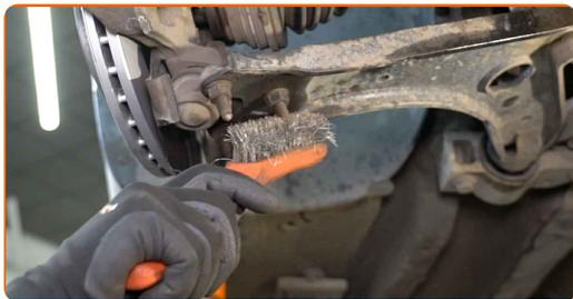
**25** Atskrūvējiet stiprinājumu, kas savieno lodbalsta savienojumu ar balstiekārtas sviru. Izmantojiet mucīņatslēgu Nr 16. Izmantojiet atslēgu ar tarkšķi.
