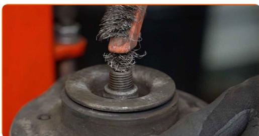
**37** Atskrūvējiet amortizatora statnes virzuļa uzgriezni. Izmantojiet mucīņatslēgu Nr 21. Izmantojiet HEX Nr. H6. Izmantojiet atslēgu ar tarkšķi.
