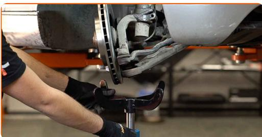
21 Atlaidiet apakšējo stiprinājumu, kas savieno amortizatora statni pie grozāmass. Izmantojiet speciālu mucīņu amortizatora demontāžai.
