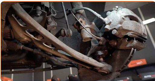
20 Paceliet grozāmasi. Izmantojiet hidraulisko transmisiju domkratu.
