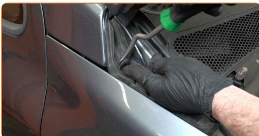
8 Atskrūvējiet bremžu šķidruma tvertnes stiprinājumus. Izmantojet Torx T20. Izmanojiet atslēgu ar tarkšķi.
