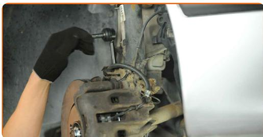
**11** Notīriet stūres šķērsstiepņa uzgaļa stiprinājumu pie grozāmass. Izmantojiet metāla birsti. Izmantojiet WD-40 aerosolu.
