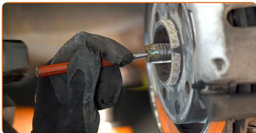
**22** Notīriet apakšējo stiprinājumu, kas savieno amortizatora statni ar grozāmasi. Izmantojiet metāla birsti. Izmantojiet WD-40 aerosolu.
