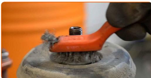
**36** Atskrūvējiet amortizatora statnes virzuļa uzgriezni. Izmantojiet kombinēto atslēgu Nr 21. Izmantojiet HEX Nr. H6. Izmantojiet atslēgu ar tarkšķi.
