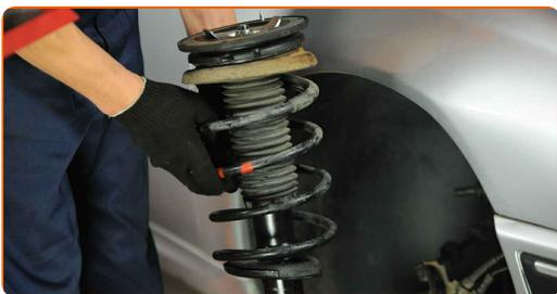
**51** Nostipriniet amortizatora statnes augšējās stiprinājumus.
