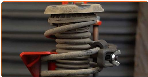
**35** Apstrādājiet amortizatora statnes kātu. Izmantojiet metāla birsti. Izmantojiet WD-40 aerosolu.
