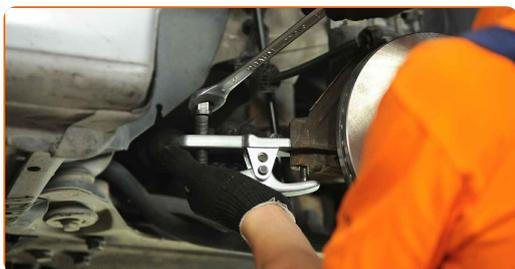
**14** Notīriet stiprinājumu, kas savieno balstiekārtas sviru ar lodbalstu. Izmantojiet metāla birsti. Izmantojiet WD-40 aerosolu.
