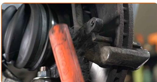
**16** Atskrūvējiet bremžu suporta kronšteina stiprinājumu. Izmantojiet mucīņatslēgu Nr 17. Izmantojiet vītņurbja atslēgu. Izmantojiet atslēgu ar tarkšķi.
