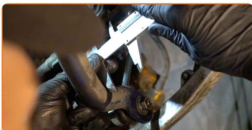
**10** Atskrūvējiet uzgaļa stiprinājuma uzgriezni pie grozāmass. Izmantojiet mucīņatslēgu Nr 21. Izmantojiet atslēgu ar tarkšķi.
