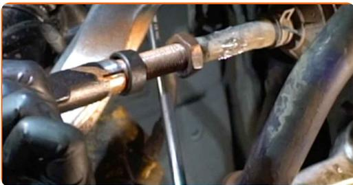
**16** Veicot demontāžu, atzīmējiet vai izmēriet precīzo lodbalsta stāvokli uz stūres šķērsstieņa, vai saskaitiet apgriezīgu skaitu, lai novērstu vēlāku savirzes neatbilstību. Izmantojiet bīdmēru.
