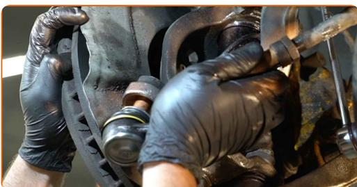
**18** Uzskrūvējiet stiprinājuma uzgriezni, kas savieno stūres šķērsstieņa uzgali ar grozāmāsi. Izmantojiet mucīnatslēgu Nr 21. Izmantojiet atslēgu ar tarkšķī.
