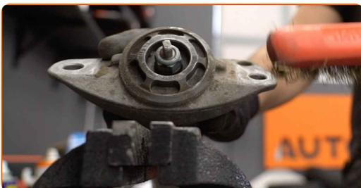
14 Notīriet amortizatora kāta stiprinājumus. Izmantojiet metāla birsti. Izmantojiet WD-40 aerosolu.
