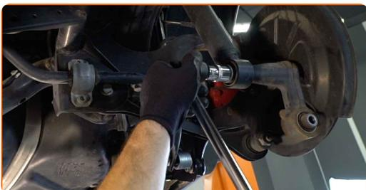
11 Atskrūvējiet amortizatora augšējo stiprinājumu. Izmantojiet mucīnatslēgu Nr 15. Izmanojiet atslēgu ar tarkšķi.
