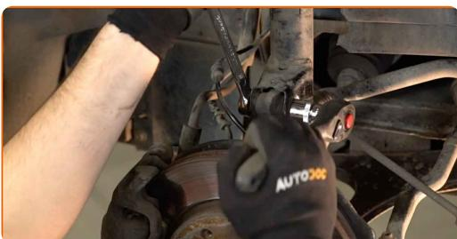
33 Nostipriniet stabilizatora atsaiti uz piekares statņa. Izmantojiet mucīņatslēgu Nr 16. Izmantojiet dinamometrisko atslēgu. Griezes moments 45 Nm.
