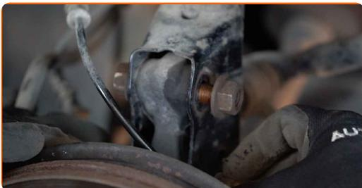
32 Pievelciet amortizatora statnes apakšējos stiprinājumus pie grozāmass. Izmantojiet mucīņatslēgu Nr 18. Izmantojiet kombinēto atslēgu Nr 18. Izmantojiet dinamometrisko atslēgu. Griezes moments 100 Nm.
