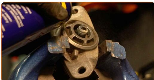
**19** Noņemiet amortizatora virzuļa stienņa stiprinājumu. Izmantojiet amortizatora mucīņu atslēgu DDN<sup>®</sup>6. Izmantojiet mucīņatslēgu Nr 16. Izmantojiet atslēgu ar tarkšķī.
