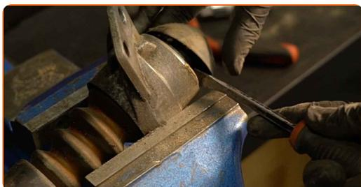
**18** Notīriet amortizatora kāta stiprinājumus. Izmantojiet metāla birsti. Izmantojiet WD-40 aerosolu.
