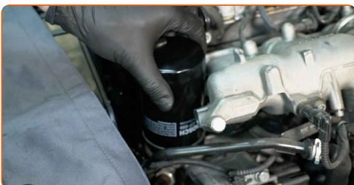
**16** Pieskrūvējiet jauno filtru tam paredzētajā vietā. Izmantojiet 76-14F uzgali. Izmantojiet dinamometrisko atslēgu. Griezes moments 18 Nm.
