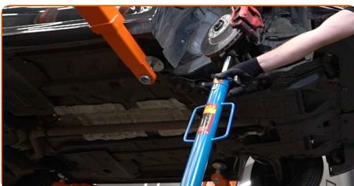
16 Atskrūvējiet amortizatora statnes apakšējos stiprinājumus pie grozāmass. Izmantojiet uzmaucamo uzgriežņa atslēgu Nr. 17. Izmantojiet mucīņatslēgu Nr 15. Izmantojiet atslēgu ar tarkšķi.
