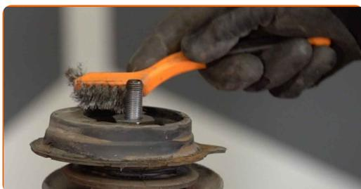
24 Atskrūvējiet amortizatora statnes virzuļa uzgriezni. Izmantojiet kombinēto atslēgu Nr 27. Izmantojiet HEX Nr. H7.
