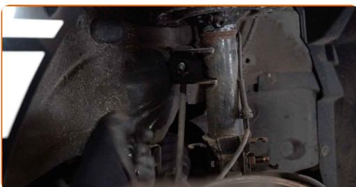
15 Paceliet grozāmasi. Izmantojiet hidraulisko transmisiju domkratu.
