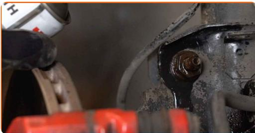
14 Atskrūvējiet uzgriezni un noņemiet stabilizatora stiepi no amortizatora statņa. Izmantojiet uzmaucamo uzgriežņa atslēgu Nr. 18. Izmantojiet mucīņatslēgu Nr 18. Izmantojiet HEX Nr. H5.
