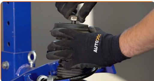
27 Pievelciet amortizatora statņa klaņa uzgriezni. Izmantojiet uzmaucamo uzgriežņa atslēgu Nr. 27. Izmantojiet HEX Nr. H7. Izmantojiet dinamometrisko atslēgu. Griezies moments 60 Nm.
