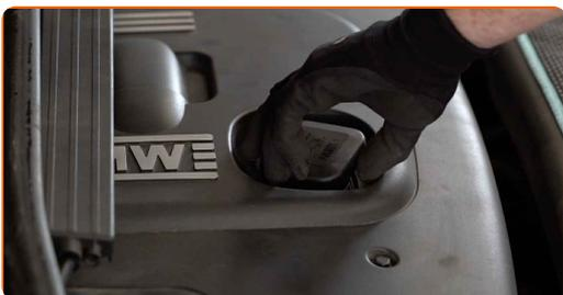
**4** Atskrūvējiet filtra korpusa vāku kopā ar veco filtrējošo elementu. Izmantojiet mucīņatslēgu Nr 36. Izmantojiet atslēgu ar tarkšķī.
