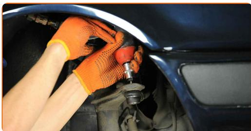
16 Nostipriniet uzgaļa pretuzgriezni. Izmantojiet kombinēto atslēgu Nr 14. Izmantojiet kombinēto atslēgu Nr 22. Izmantojiet dinamometrisko atslēgu. Griezies moments 40 Nm.
