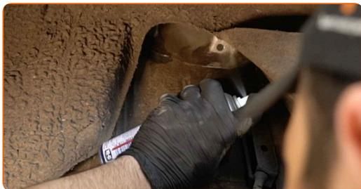
**27** Ievietojiet amortizatoru riteņa arkā un nostipriniet to.
