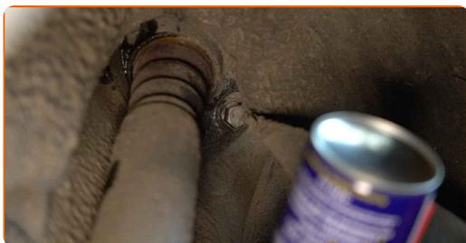
**10** Atskrūvējiet amortizatora apakšējo stiprinājumu. Izmantojiet kombinēto atslēgu Nr 18. Izmantojiet mucīņatslēgu Nr 18. Izmantojiet atslēgu ar tarkšķi.
