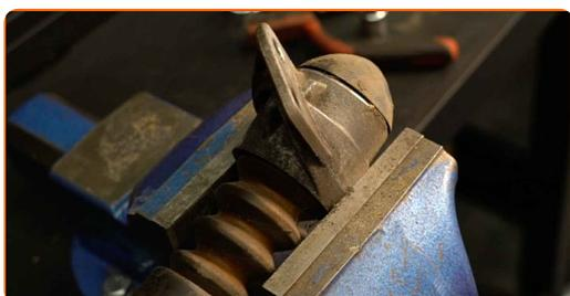
**17** Noņemiet amortizatora balsta aizsargvāciņu. Izmantojiet montāžas sviru.
