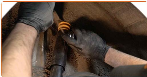
**33** Notīriet detaļas un uztriepiet plānu smērvielas kārtiņu uz gultņa sēžas. Izmantojiet mucīņatslēgu Nr 18. Izmantojiet dinamometrisko atslēgu. Griezes moments 120 Nm.
