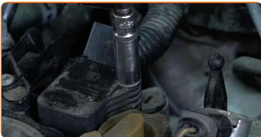
**17** Izmantojot elektrokontakta aerosolu, apstrādājiet aizdedzes spoles kontaktligzdu. Aerosols pasargās elektrokontaktus no korozijas, oksidācijas, kā arī samazinās kontaktu pretestību.
