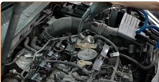
**9** Izskrūvējiet aizdedzes sveces. Izmantojiet aizdedzes sveču atslēgu Nr. 16. Izmantojiet atslēgu ar tarkšķi.
