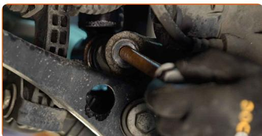
**25** Atbalstiet sviru. Izmantojiet hidraulisko transmisiju domkratu.
