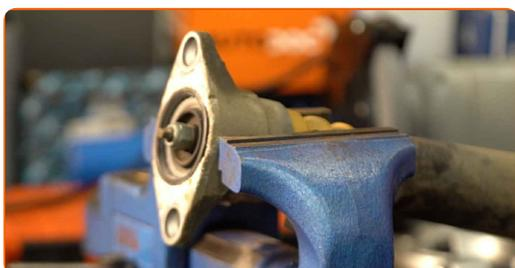
**17** Notīriet amortizatora kāta stiprinājumus. Izmantojiet metāla birsti. Izmantojiet WD-40 aerosolu.
