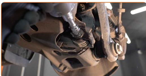
**8** Notīriet stabilizatora bukšu kronšteinu stiprinājumus. Izmantojiet metāla birsti. Izmantojiet WD-40 aerosolu.
