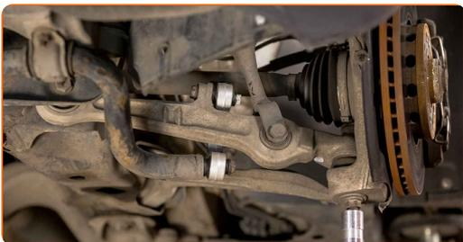
**16** Pievelciet stiprinājumu, kas savieno stabilizatora atsaiti pie stabilizatora stieņa. Izmantojiet kombinēto atslēgu Nr 16. Izmantojiet dinamometrisko atslēgu. Griezes moments 40 Nm. +90°
