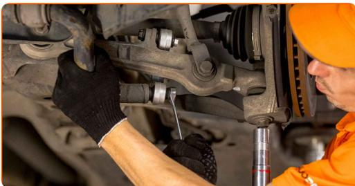
**15** Atbalstiet sviru. Izmantojiet hidraulisko transmisiju domkratu.
