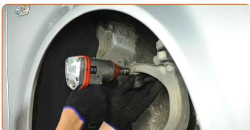
**20** Nostipriniet uzgaļa pretuzgriezni. Izmantojiet kombinēto atslēgu Nr 19. Izmantojiet kombinēto atslēgu Nr 22. Izmantojiet dinamometrisko atslēgu. Griezes moments 40 Nm.
