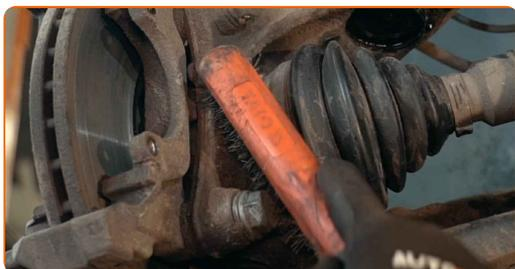
**17** Atskrūvējiet bremžu suporta kronšteina stiprinājumu. Izmantojiet mucīnatslēgu Nr 21. Izmantojiet atslēgu ar tarkšķi. Izmantojiet vītņurbja atslēgu.
