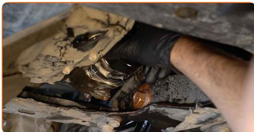
**22** Uzskrūvējiet vāku. Izmantojiet 67-14F uzgali. Izmantojiet dinamometrisko atslēgu. Griezes moments 25 Nm.
