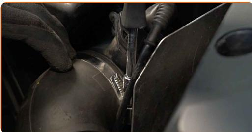
**18** Nostipriniet ieplūdes gaisvada šļūteni. Izmantojiet Torx T20.
