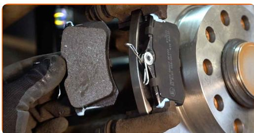
**34** Uzstādiet bremžu suportu un piestipriniet to. Izmantojiet mucīnatslēgu Nr 13. Izmantojiet kombinēto atslēgu Nr 15. Izmantojiet dinamometrisko atslēgu. Griezes moments 35 Nm.
