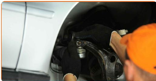
**18** Pievelciet stūres stiepņa uzgaļa stiprinājuma uzgriezni pie grozāmass. Izmantojiet mucīņatslēgu Nr 13. Izmantojiet dinamometrisko atslēgu. Griezies moments 7 Nm.
