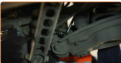
**14** Pievelciet stiprinājumu, kas savieno stabilizatora atsaiti pie stabilizatora stieņa. Izmantojiet kombinēto atslēgu Nr 17 (2 gab.). Izmantojiet dinamometrisko atslēgu. Griezes moments 58 Nm.
