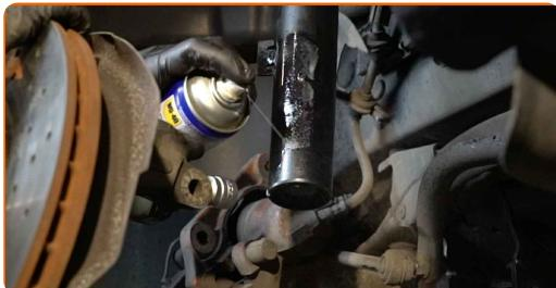
**60** Nostipriniet amortizatora statni uz grozāmass.
