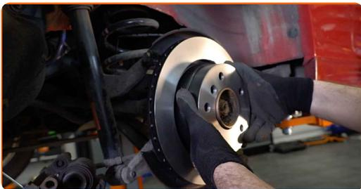
**23** Pievelciet bremžu diska stiprinājumu. Izmantojiet Torx T 30. Izmantojiet dinamometrisko atslēgu. Griezes moments 16 Nm.
