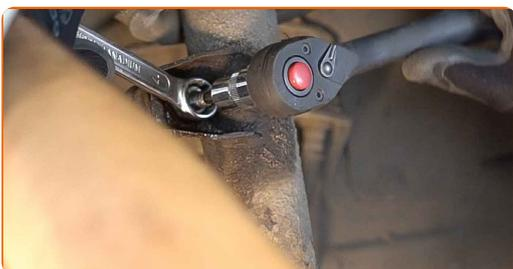
**11** Apstrādājiet kronšteinu, kas nostiprina bremžu šļūteni un vadojumu. Izmantojiet WD-40 aerosolu.
