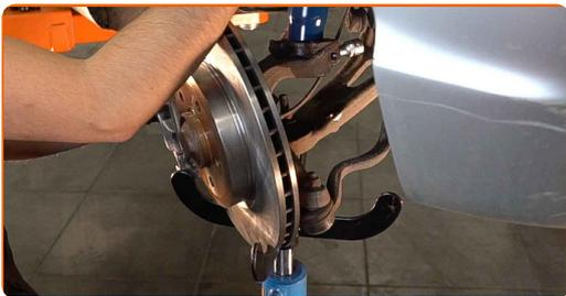
**47** Nostipriniet amortizatora statni uz grozāmass.
