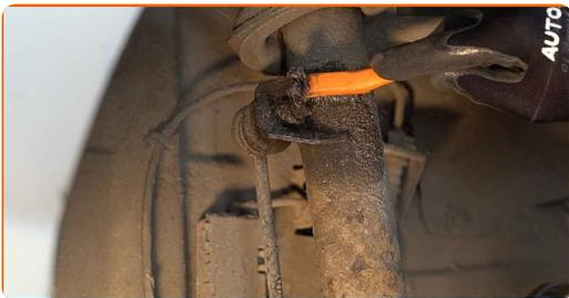
**10** Atskrūvējiet uzgriezni un noņemiet stabilizatora stiepi no amortizatora statņa. Izmantojiet HEX Nr. H7. Izmantojiet kombinēto atslēgu Nr 17. Izmantojiet atslēgu ar tarkšķī.
