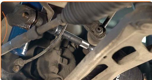
**49** Pievelciet amortizatora statnes apakšējos stiprinājumus pie grozāmass. Izmantojiet mucīņatslēgu Nr 18. Izmantojiet dinamometrisko atslēgu. Griezies moments 80 Nm.
