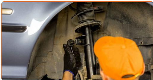
62 Pievelciet stiprinājumu, kas savieno stabilizatora atsaiti pie amortizatora statnes. Izmantojiet mucīņatslēgu Nr 17. Izmantojiet dinamometrisko atslēgu. Griezes moments 60 Nm.
