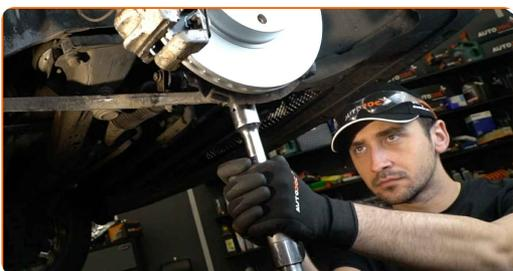
**16** Pievelciet stiprinājumu, kas savieno stabilizatora stieni ar balstiekārtas sviru. Izmantojiet kombinēto atslēgu Nr 17. Izmantojiet mucīņatslēgu Nr 17. Izmantojiet dinamometrisko atslēgu. Griezes moments 42 Nm.
