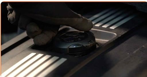
**4** Atskrūvējiet filtra korpusa vāku kopā ar veco filtrējošo elementu. Izmantojiet 86-16F uzgali. Izmantojiet atslēgu ar tarkšķī.
