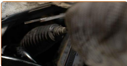
**19** Nostipriniet uzgaļa pretuzgriezni. Izmantojiet kombinēto atslēgu Nr 17. Izmantojiet kombinēto atslēgu Nr 19. Izmantojiet dinamometrisko atslēgu. Griezes moments 47 Nm.
