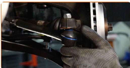
**18** Veicot demontāžu, atzīmējiet vai izmēriet precīzo lodbalsta stāvokli uz stūres šķērsstiepņa, vai saskaitiet apgriezienu skaitu, lai novērstu vēlāku savirzes neatbilstību. Izmantojiet bīdmēru.
