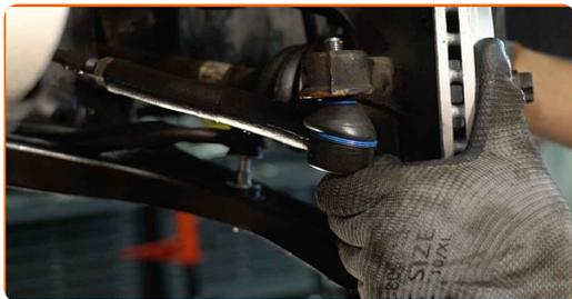
**17** Uzskrūvējiet stiprinājuma uzgriezni, kas savieno stūres šķērsstiepņa uzgali ar grozāmāsi. Izmantojiet mucīņatslēgu Nr 19. Izmantojiet atslēgu ar tarkšķī.
