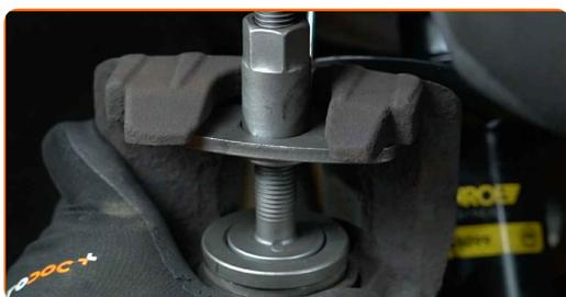
**29** Uzstādiet bremžu suportu un piestipriniet to. Izmantojiet mucīņatslēgu Nr 13. Izmantojiet dinamometrisko atslēgu. Griezes moments 30 Nm.
