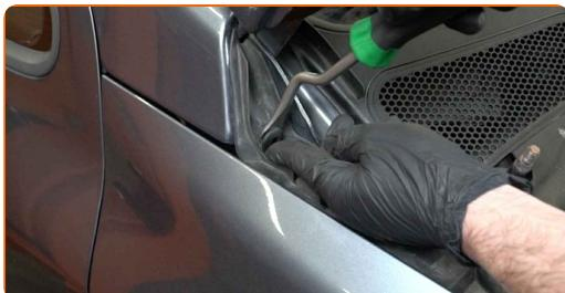
8 Atskrūvējiet bremžu šķidruma tvertnes stiprinājumus. Izmantojiet Torx T20. Izmanojiet atslēgu ar tarkšķi.
