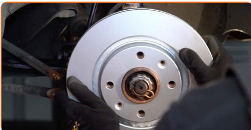
**20** Pievelciet bremžu diska stiprinājumu. Izmantojiet krustiņu skrūvgriezi. Izmantojiet dinamometrisko atslēgu. Griezes moments 9 Nm.
