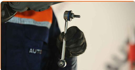
**13** uzstādiet stieņa stiprinājumu uz stabilizatora un pievelciet to. Izmantojiet mucīņatslēgu Nr 13. Izmantojiet dinamometrisko atslēgu. Griezes moments 21 Nm.
