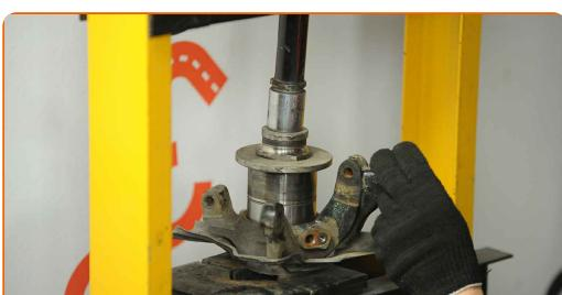
33 Pievelciet amortizatora statnes apakšējos stiprinājumus pie grozāmass. Izmantojet kombinēto atslēgu Nr 17. Izmantojet mucīnatslēgu Nr 17. Izmantojet dinamometrisko atslēgu. Griezes moments 75 Nm.
