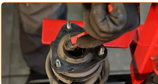
**34****Atskrūvējiet amortizatora statnes virzuļa uzgriezni. Izmantojiet HEX Nr. H6. Izmantojiet muciņatslēgu Nr 17. Izmanojiet atslēgu ar tarkšķi.**
