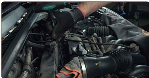
**16** Ieskrūvējiet jaunās aizdedzes sveces un nostipriniet tās. Izmantojiet aizdedzes sveču atslēgu Nr. 16. Izmantojiet dinamometrisko atslēgu. Griezes moments 15 Nm.
