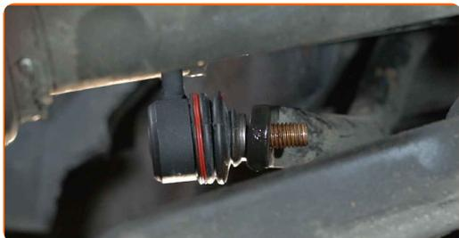
**12** Pievelciet stabilizatora statņa stiprinājumu. Izmantojiet kombinēto atslēgu Nr 17. Izmantojiet mucīņatslēgu Nr 17. Izmantojiet atslēgu ar tarkšķi.
