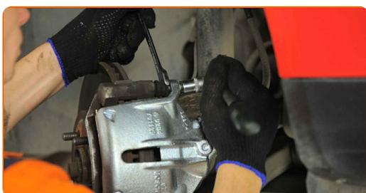
**21** Pievelciet stiprinājumu, kas savieno bremžu šļūteni pie bremžu suporta. Izmantojiet bremžu cauruļu atslēgu Nr. 14. Izmantojiet dinamometrisko atslēgu. Griezes moments 18 Nm.
