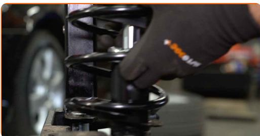
51 Notīriet amortizatora statnes montāžas vietas. Izmantojiet metāla birsti. Izmantojiet WD-40 aerosolu.
