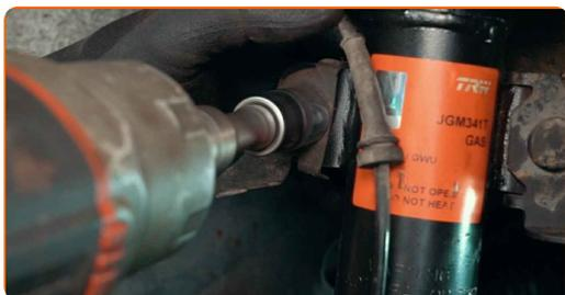
**74** Pievelciet stiprinājumu, kas savieno stabilizatora atsaiti pie amortizatora statnes. Izmantojiet mucīņatslēgu Nr 17. Izmantojiet dinamometrisko atslēgu. Grieznes moments 48 Nm.
