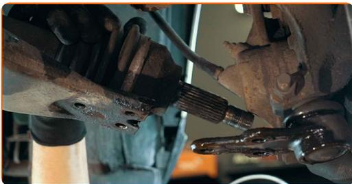
**28** Paceliet grozāmasi. Izmantojiet hidraulisko transmisiju domkratu.
