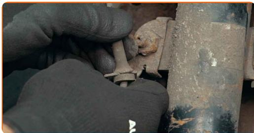
**13** Notīriet stabilizatora atsaites stiprinājumus. Izmantojiet metāla birsti. Izmantojiet WD-40 aerosolu.
