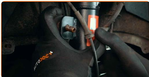
**73** Pievelciet stabilizatora statņa stiprinājumu. Izmantojiet mucīņatslēgu Nr 17. Izmantojiet atslēgu ar tarkšķī.
