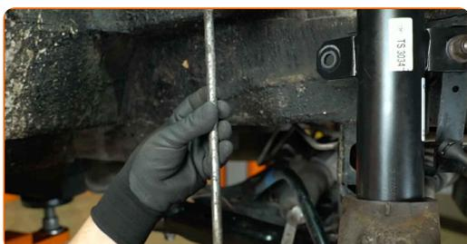
**10** Veiciet tās pašas darbības, lai noņemtu otru šķērsstabilizatora stieپni.
