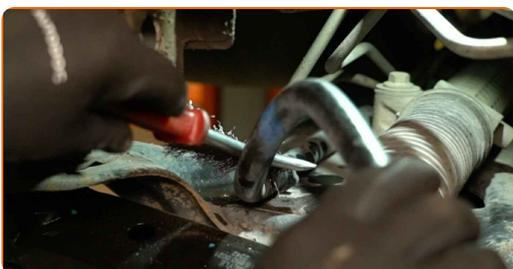
**18** Uzstādiet jaunu šķērsstabilizatora buksi vienā ass pusē.
