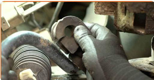
**16** Veiciet tās pašas darbības, lai noņemtu otras šķērsstabilizatora bukses kronšteinu un pašu buksi.
