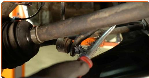
**7** Atskrūvējiet stiprinājumu, kas savieno šķērsstabilizatora stiepni ar šķērsstabilizatoru. Izmantojiet kombinēto atslēgu nr. 19. Lai nostiprinātu lodgalvas tapu, izmantojiet sešstūra atslēgu H5. Izmantojiet sprūdatslēgu.
