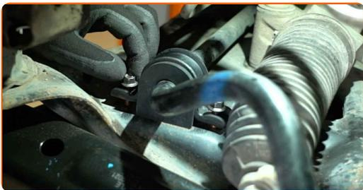
**21** Veiciet tās pašas darbības, lai uzstādītu jaunu šķērsstabilizatora buksi un kronšteinu otrā pusē.
