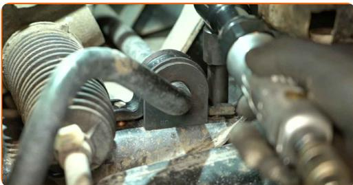
**22** Pievelciet abu šķērsstabilizatora bukšu kronšteinu stiprinājumus. Izmantojiet mucīņas uzgali nr. 10. Izmantojiet dinamometrisko atslēgu. Pievilkšanas griezes moments: 25 N·m.
