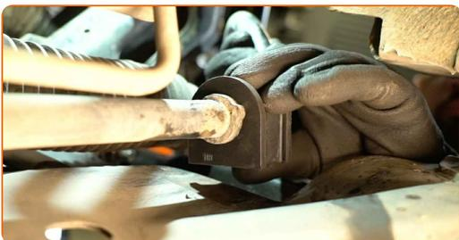
**19** Uzstādiet šķērsstabilizatora bukses kronšteinu.
