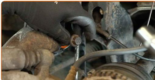
**42** Atvienojiet grozāmasi no amortizatora statņa. Izmantojiet gumijas āmuru. Izmantojiet transmisijas domkratu vai vēl vienu transportlīdzekļa domkratu.
