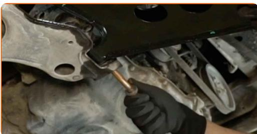
**19** Pievienojiet lodbalstu balstiekārtas svirai, uzskrūvējot uzgriezni.
