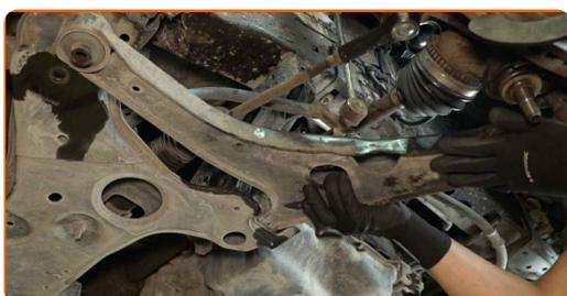
**16** Notīriet balstiekārtas sviras montāžas sēžas. Izmantojiet stieplu suku. Izmantojiet universālo tīrīšanas aerosolu.
