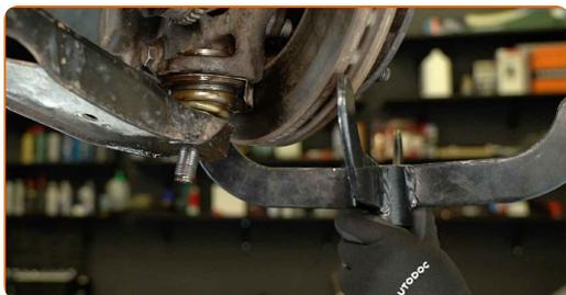
**9** Atvienojiet lodbalstu no balstiekārtas sviras. Izmantojiet lodbalstu noņēmēju.
