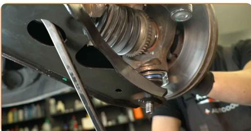
**20** Pievelciet stiprinājumu, kas savieno balstiekārtas sviru ar lodbalstu. Izmantojiet mucīņas uzgali nr. 24. Izmantojiet dinamometrisko atslēgu. Pievilkšanas griezes moments: 150 N·m.
