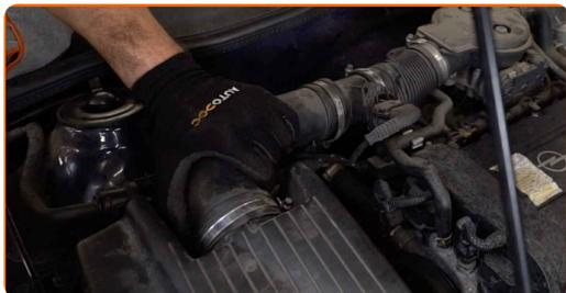
39 Nostipriniet skavu uz gaisa ieplūdes caurules. Izmantojiet mucīnatslēgu Nr 7. Izmanojiet atslēgu ar tarkšķi.
