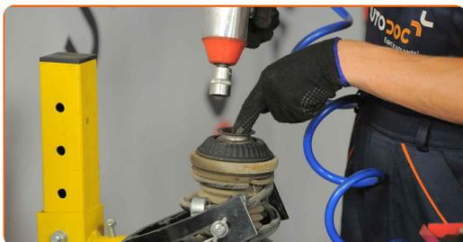
**24** Atskrūvējiet amortizatora statnes virzuļa uzgriezni. Izmantojiet mucīnatslēgu Nr 21. Izmanojiet atslēgu ar tarkšķi.
