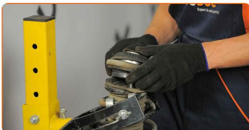
**35** Pievelciet amortizatora statņa klaņa uzgriezni. Izmantojiet mucīņatslēgu Nr 21. Izmantojiet dinamometrisko atslēgu. Griezes moments 65 Nm.
