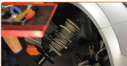
**41** Pieskrūvējiet augšējo amortizatora statņa balsta stiprinājumu. Izmantojiet santehnikas knaibles.
