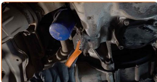
9 Atskrūvējiet iztukšošanas aizbāzni. Izmantojiet mucīnatslēgu Nr 17. Izmantojiet atslēgu ar tarkšķi.
